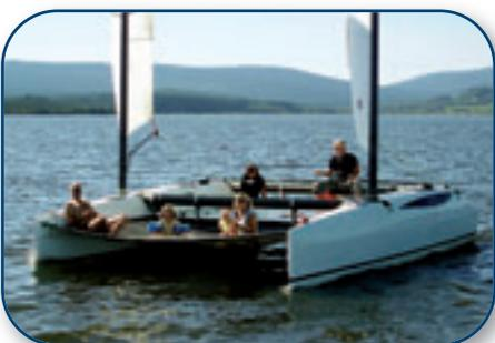
Ce catamaran est démontable et transportable et propose des aménagements pour quatre personnes. Mais l'intérêt de l'Essence 6 est sa version "Para", qui propose deux mâts rotatifs en carbone, un sur chaque coque... De quoi ne pas passer inaperçu au mouillage ! Dans sa version classique, l'Essence 6 est équipé d'un mât rotatif en alu et d'un gréement en vectran. La hauteur sous barrot dans les coques est de 1,35 mètre, ce qui permet de profiter pleinement du bateau en camping côtier.
